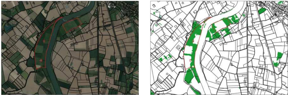
FIGURE 8.5 – Superposition des limites des parcelles cadastrales (lignes noires) sur les prédictions en peupleraies (pixels verts). Les deux parcelles délimitées en rouge montrent deux exemples de limites cadastrales imprécises.
