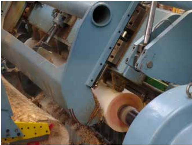
Dérouleuse en activité (vue arrière) : en bas à gauche, partie de billon écorcé en attente d'être déroulé. Au centre, billon en cours de déroulage avec à son extrémité droite l'axe en acier qui tient le billon, le fait tourner et qui va induire le noyau de déroulage non déroulé de 8 cm de diamètre.
