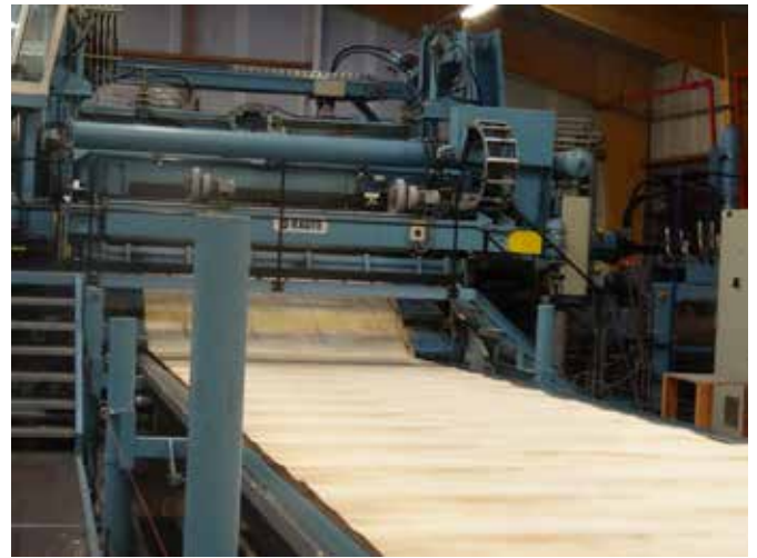
Dérouleuse en activité (vue avant) : résultat du déroulage du billon, une longue feuille de bois de quelques mm d'épaisseur, ici sans nœud apparent.
