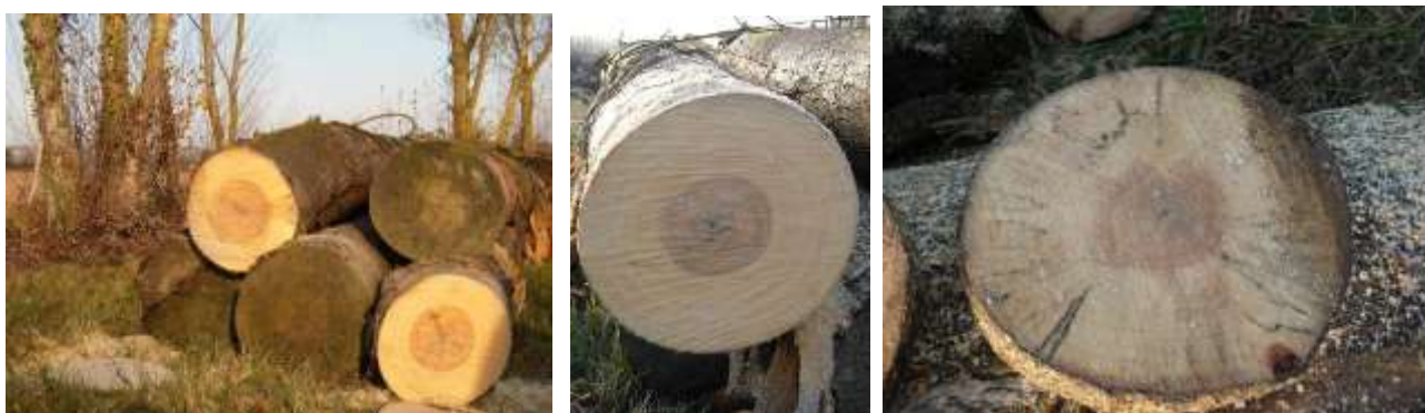
Figure 35 : Prélèvements après 16 mois de stockage par immersion, bon aspect visuel du bois : couleur claire, quelques coloration mais peut-être déjà présentes lors du stockage.
