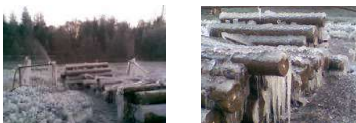
Figure 16 : Aire expérimentale de stockage sous aspersion
