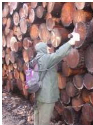
Figure 17 : Mesure de l'humidité à l'aide d'un spectromètre proche-infra-rouge portable.
