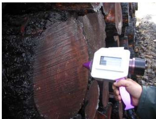
Figure 17 : Mesure de l'humidité à l'aide d'un spectromètre proche-infra-rouge portable.
