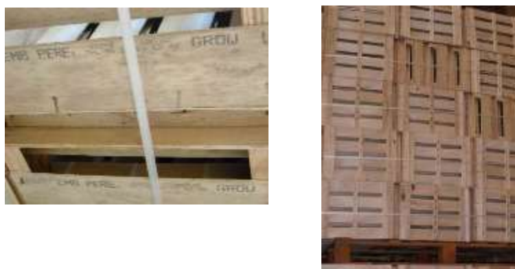
Figure 38 : Emballages réalisés à partir de placages issus de billons de peuplier stockés par immersion
