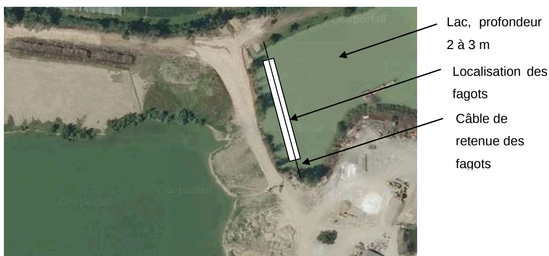
Figure 26 : Dispositif de stockage par immersion, implantation des fagots sur le site de DSL
