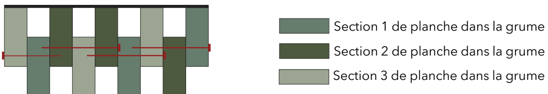
Figure 36: Schéma de la dalle peuplier avec des sections prélevées dans la même grume
