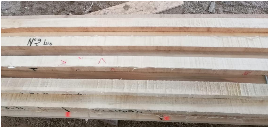
Figure 64: Photo des différentes fissures suite à rupture de la dalle 2 bis
