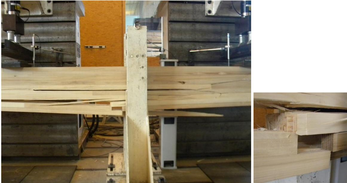
**Photo 3** : rupture d'un aboutage lors d'un essai de flexion 4 points selon la norme EN 14080 annexe F sur poutre BLC en grandeur d'emploi
