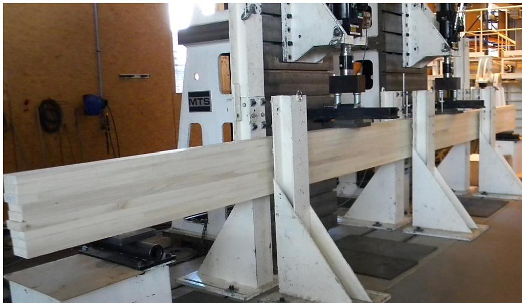
**Photo 2** : essai de flexion 4 points selon la norme EN 14080 annexe F sur poutre BLC en grandeur d'emploi
