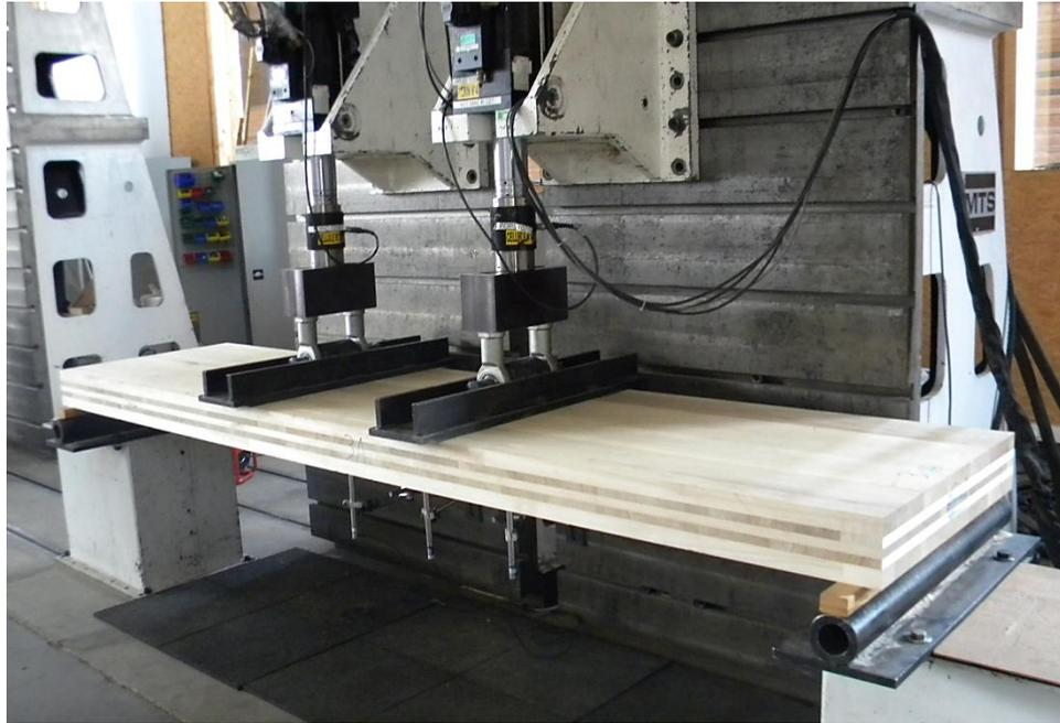
**Photo 5** : essai de flexion 4 points selon la norme EN 16351 sur panneau CLT en grandeur d'emploi
