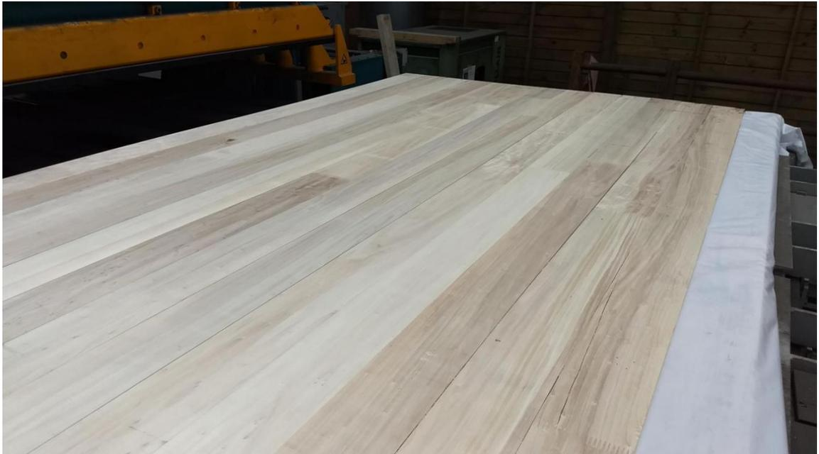
Photo 4 : Fabrication prototype de panneaux CLT
