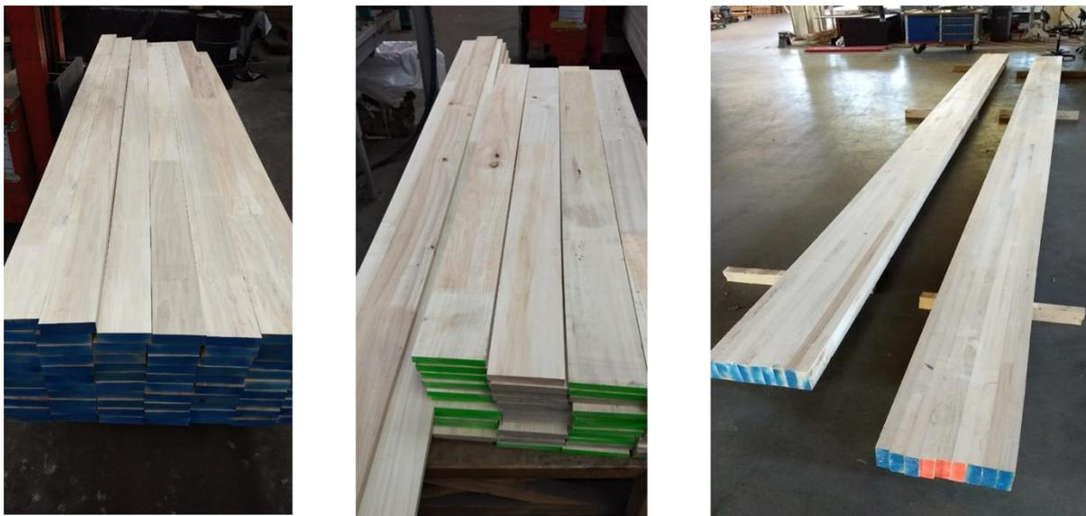
Photo 1 : Fabrication prototype de poutres BLC
