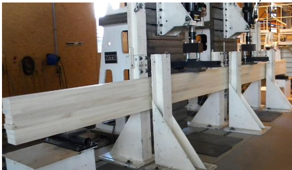
Essai de flexion 4 points selon la norme EN 14080 sur poutre BLC en grandeur d'emploi
