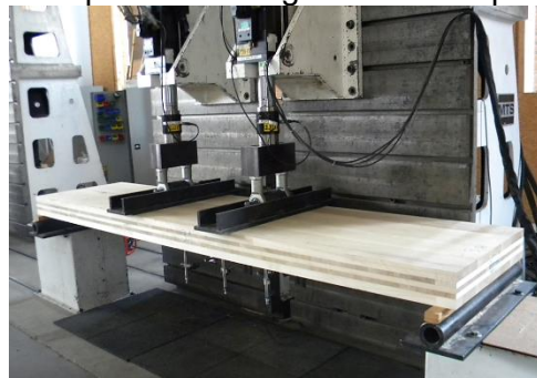
Essai de flexion 4 points selon la norme EN 16351 sur panneau CLT en grandeur d'emploi
